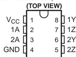
**Pin Functions: SN55LVDS31 J or W, SN65LVDS31 D or PW**
